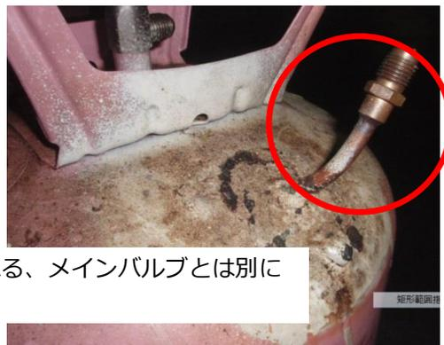
参考：再充填が目的と推測される、メインバルブとは別に口金が溶接されたNRC容器。
