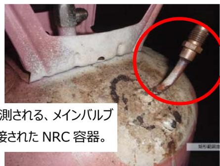
参考：再充填が目的と推測される、メインバルブとは別に口金が溶接された NRC 容器。
